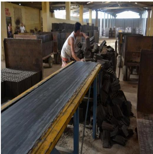
**Figuras 3 e 4:** Vista de trabalho braçal dentro da cerâmica, sem a utilização dos equipamentos de segurança
