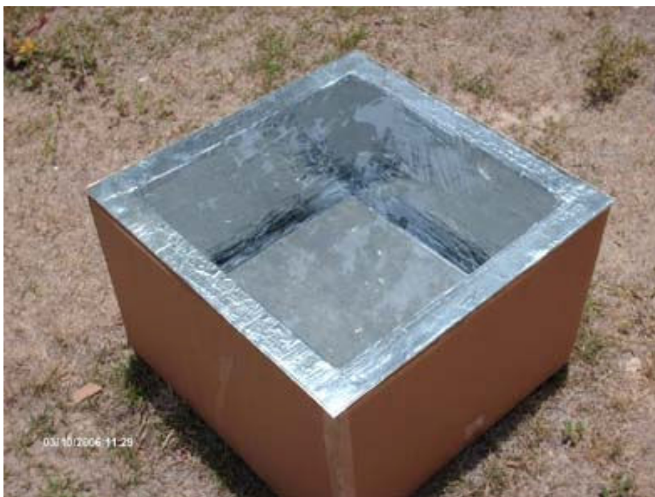
Figura 1 – Fogão solar do tipo caixa feito em papelão
