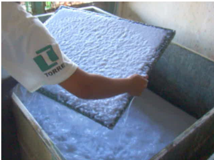
Fig. 1- Aulas práticas de reciclagem fornecidas pela Sociedade Ecoar. Papel batido sendo retirado com a peneira (molde) do tanque.
